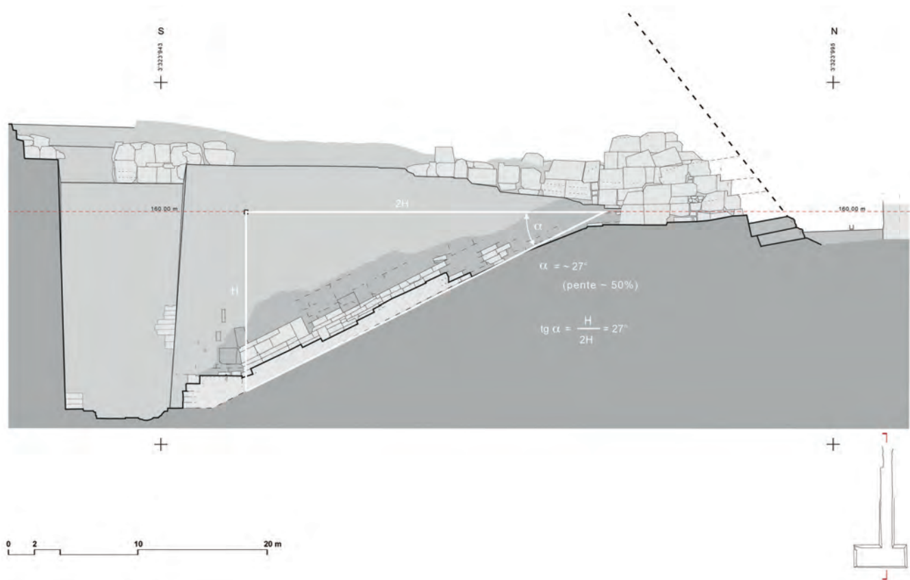
Ill. 4 – Schéma de détermination de la pente de la descenderie
