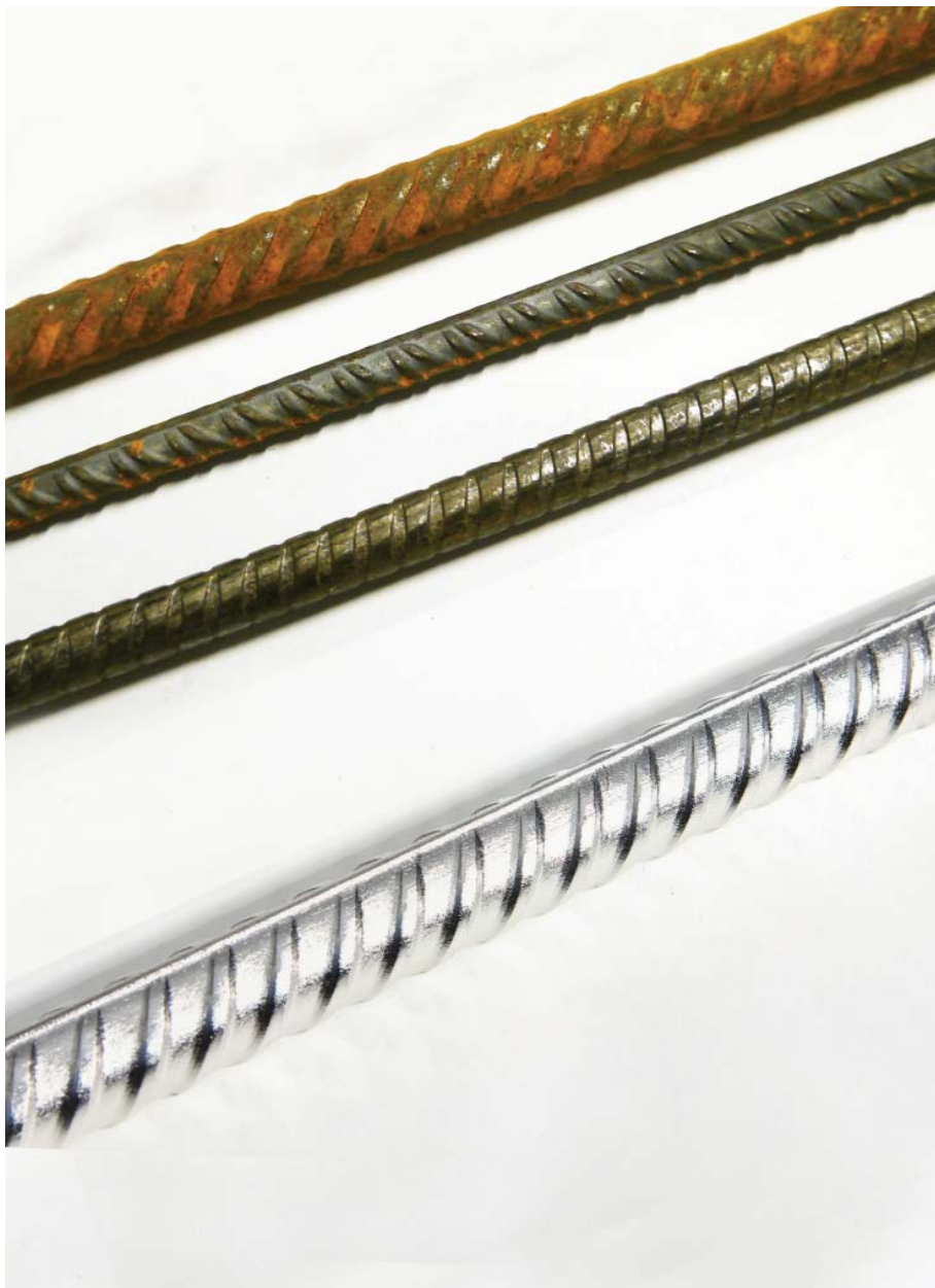
Détail du relief d'un fer à béton, rouillé ou inoxydable
